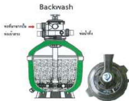
รูปที่ 1.9.2-1 หลักการ Backwash เครื่องกรองทรายของระบบกรองน้ำสระว่ายน้ำ
